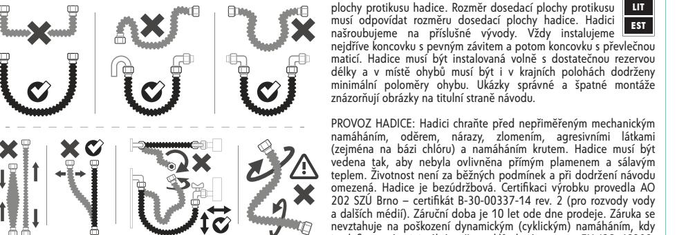
**CZE ČEŠTINA:** STAVBA A POUŽITÍ HADICE: hadice Flexira xConnect Aqua je obchodním označením hadic WS110 DN8, DN10 nebo DN12. Hadice je tvorená nerezovým vlnovcom typu 2-10 ale EN ISO 10380, dveďm párvanými nerezovými koncovkami (prevlečná maticniklovaná mosaz) a ochrannou plastovou vrstvou. Hadice je primárne určená pre dopojovanie v rozvodoch užívateľov k pitnej vode, prípadne tam, kde pri dodržení návodu a hodnot stanovených predpisov svými vlastnostmi využívajú účelu použitia.
